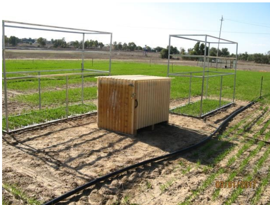
איור 3. שני תאי מדידה פתוחים בצדם העליון (בשעת הצילום הדפנות מפורקות), בתוך הארגז מוצב מחולל האוזון ומשאבות.
